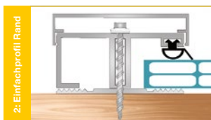
Auflagegummi unten, Randprofil oben, Klemmdeckel (optional)
